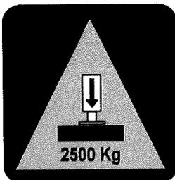
Ausreichende Stabilität der Befestigungspunkte am Fahrgestell auswählen. Berücksichtigen Sie, dass jede Stütze eine Hubkraft von 2500 kg aufweist. Nötigenfalls müssen die Befestigungspunkte mit geeigneten Mitteln verstärkt werden.
