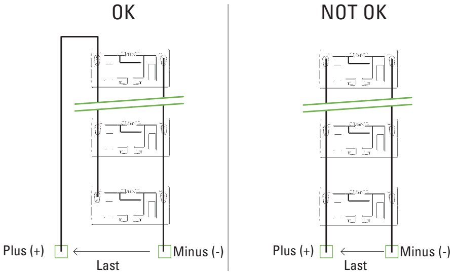
Abbildung 18. Parallelschaltung von Li-Ionen-Batterien
